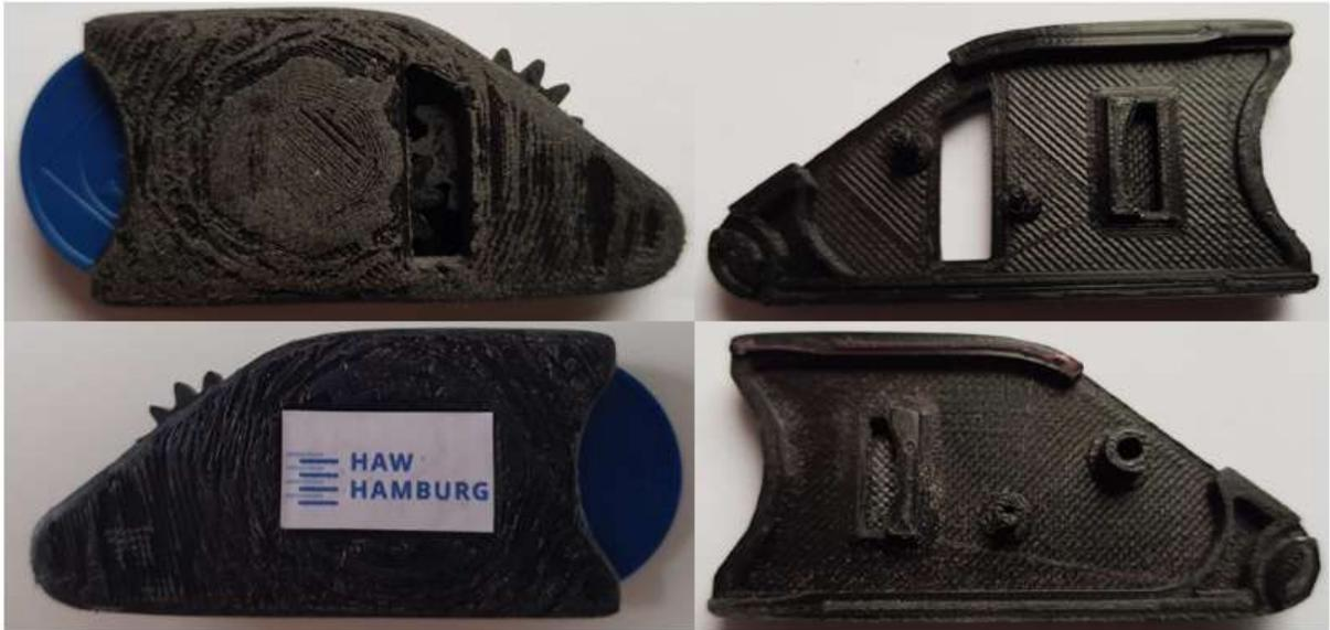
Abbildung 30: Endgültige Zusammenbau des Schlüsselanhängers [Eigene Darstellung]
