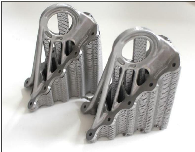
Abbildung 2.5 Beispiel für eine Anwendung von Stützstruktur am Airbus A350 XWB Bracket [14]
