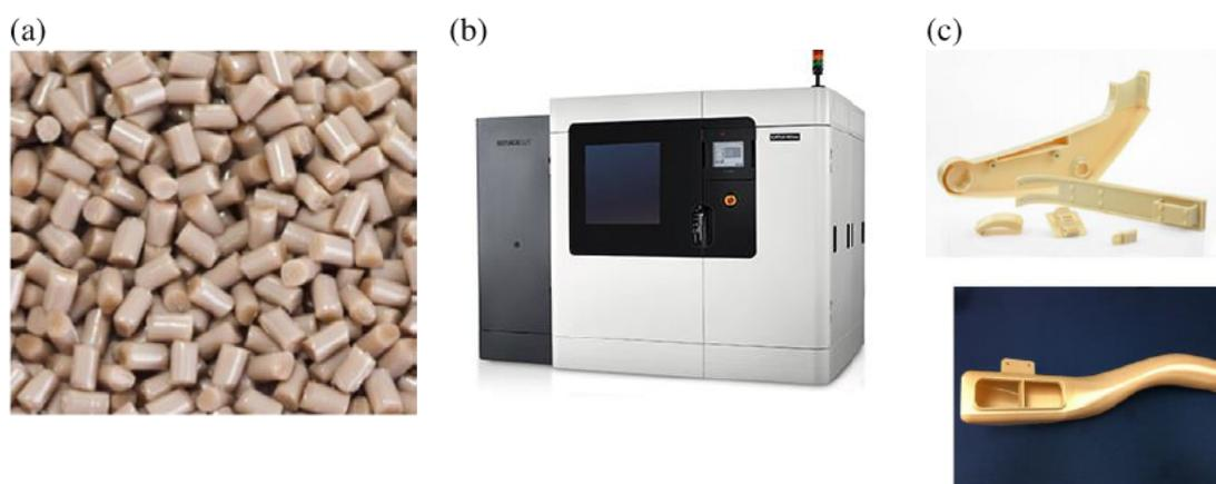
**Abbildung 5.11** Zusammensetzung des Stratasys Prozesses mit (a) Granulat des Certified ULTEM 9085 Resin [72], (b) Stratasys Fortus 900mc [73], (c) zugelassene Bauteile im Airbus A350 [71]
