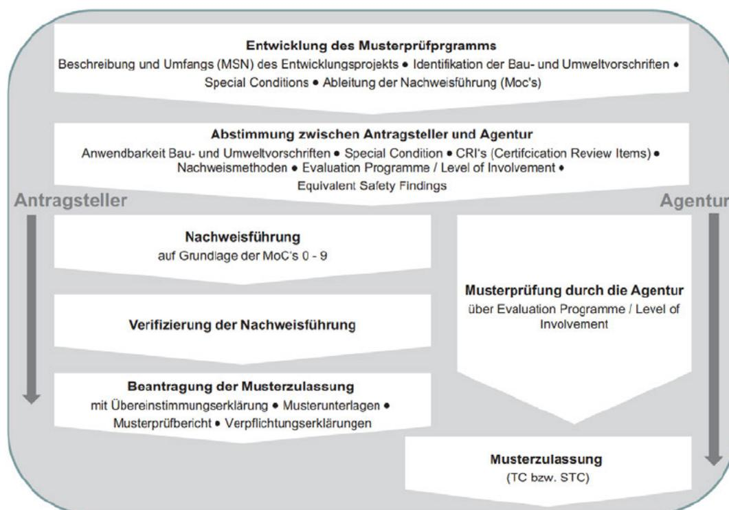
Abbildung 3.3 Ablauf eines Zulassungsprozesses (Musterprogramm). Aus [26]
