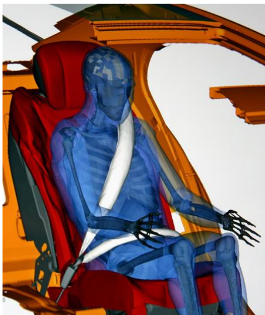
Abbildung 6-18: Detaillierter Simulationsaufbau eines Insassen (rechts) [MPA2012] und angepasste Modellierung des Dummymodells (links)
