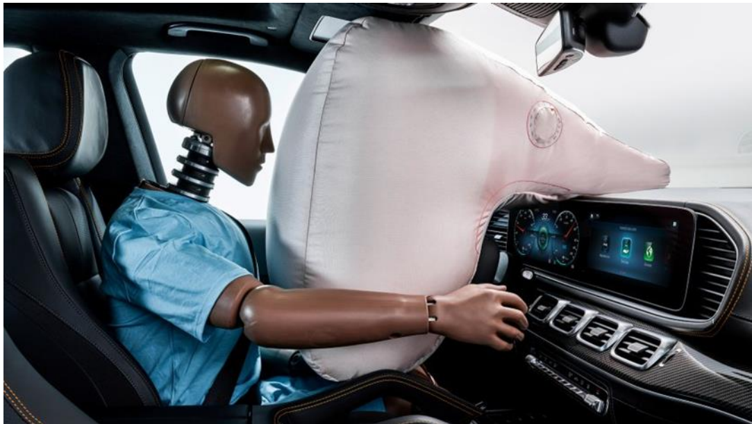
Abbildung 2-16: Airbagsystem auf der Fahrerseite des ESF [DAI2020]
