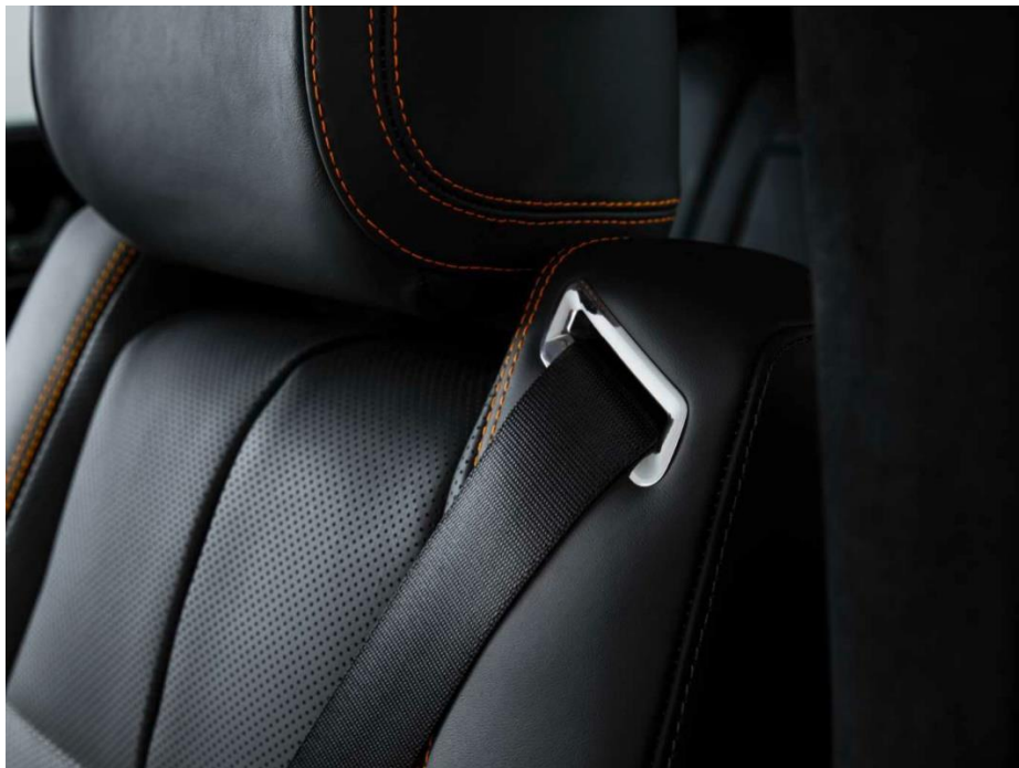
Abbildung 2-15: Gurtintegralsitz des ESF 2019 [DAI2020]
