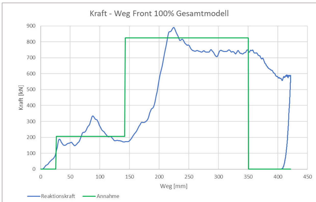
Abbildung 3-10: Vergleich der Kraft-Weg Verlaufs aus der Simulation und der Randbedingungen
