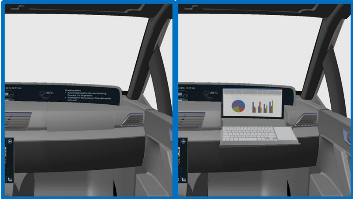
Abbildung 2-24: Bedienfeld auf der Beifahrerseite eingeklappt (links) und ausgeklappt (rechts) [HCC2021]
