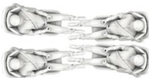
Abbildung 1-1: Fahrzeuginnenraumkonzepte in hohen Automatisierungsstufen – daraus abgeleitete Beispiele für Sitzkonfigurationen [Laa2019]
