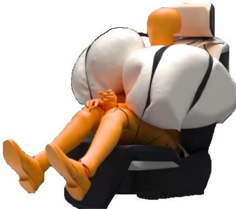
Abbildung 2-18: Cocoun Airbag für den ZeroG Lounger von BMW [BMW2020]
