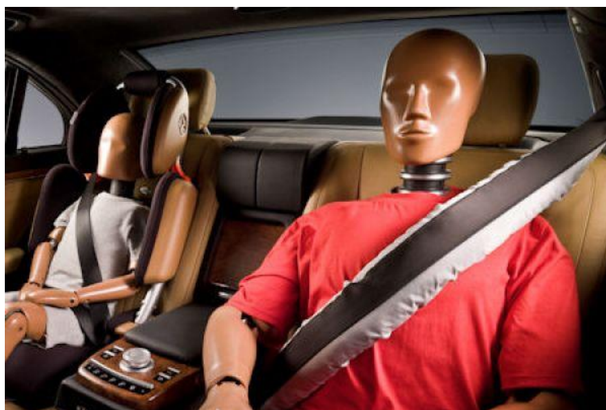
Abbildung 2-6: Gurt-Bag zur Vergrößerung der wirksamen Gurtband-Breite im ESF 2009 von Mercedes-Benz [CHR2009]
