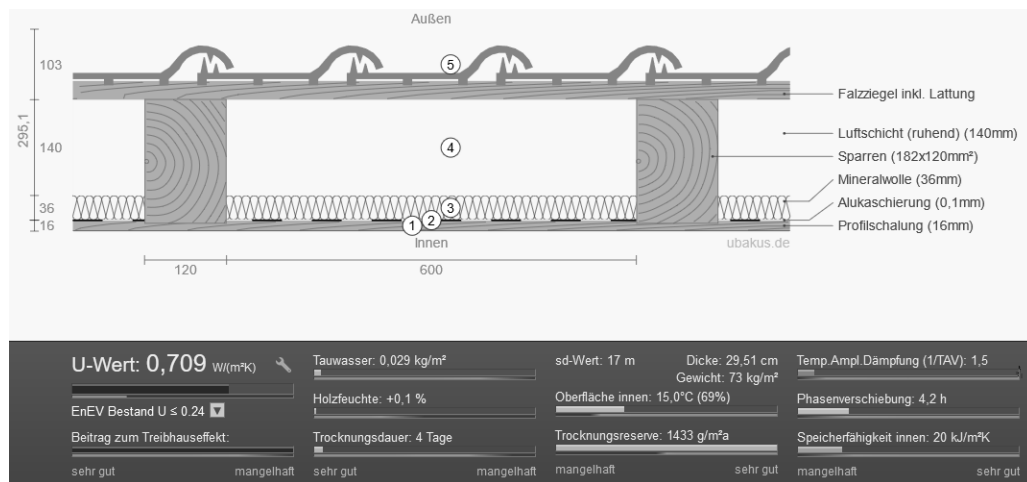
Anhang Abbildung 19: Dach- Ist-Zustand (erstellt mit Ubakus)
