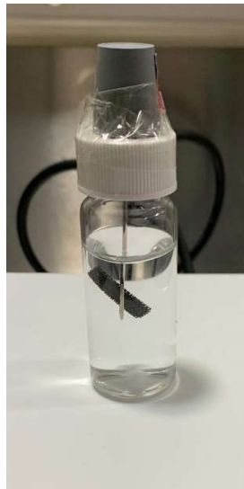
Abbildung 11: Aufbau der TF-SPME-Extraktion
