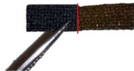
Abbildung 19: Vergleich einer unbenutzten und einer benutzten TF-SPME-Membran
