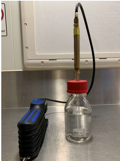
Abbildung 8: Aufbau Purge & Trap
