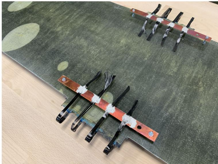
Abbildung 4.1: Anschluss der Heizwiderstände des Versuchspaneels
