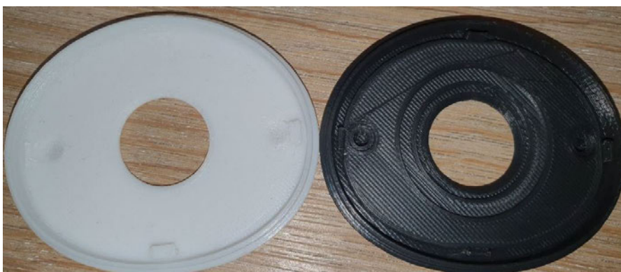
Abbildung 92 Außenverkleidung links erste Version / rechts zweite Version mit Abschluss Scheibenträger
