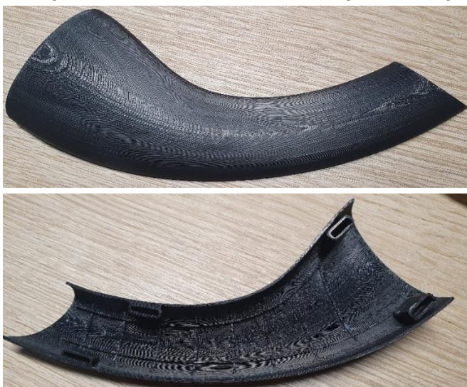
Abbildung 88 Prototyp untere Verkleidung des Grundträgers in zwei Ansichten
