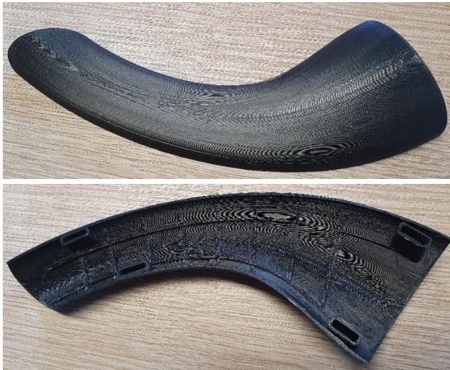
Abbildung 87 Prototyp obere Verkleidung des Grundträgers in zwei Ansichten
