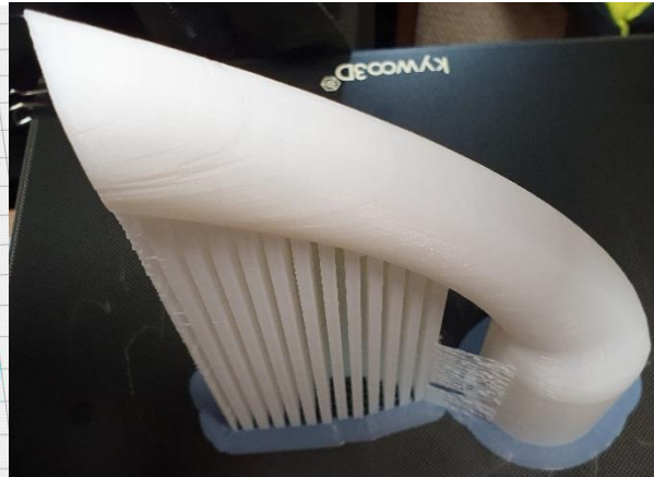
Abbildung 82 Grundträger nach Abschluss des Druckvorganges
