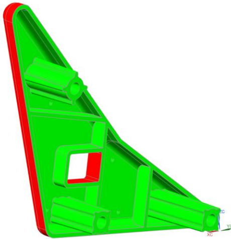
Abbildung 50 Draft Analyse Rohteil
