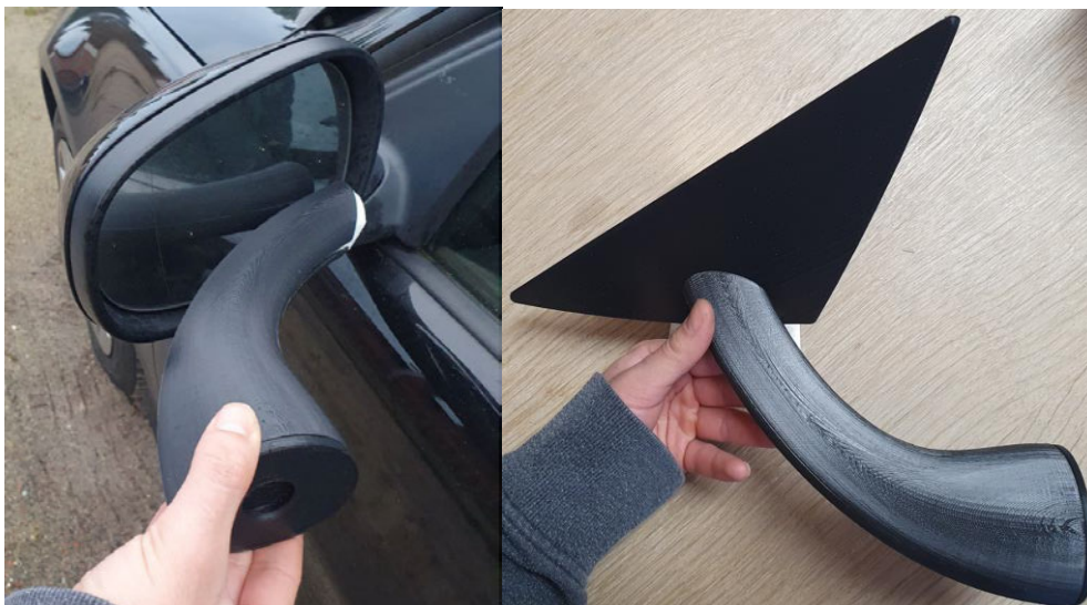
Abbildung 94 Prototyp am Fahrzeug
