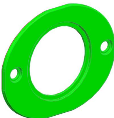
Abbildung 58 Draft Analyse Abschluss Scheibenträger
