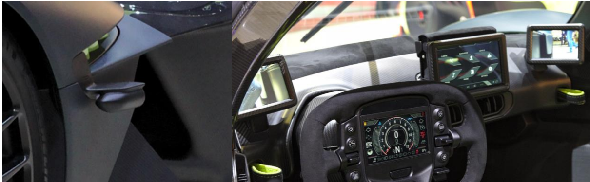
Abbildung 15 Aston Martin Valkyrie Kamera [23] Abbildung 16 Aston Martin Valkyrie Monitor [23]
