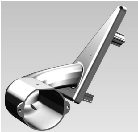
Abbildung 69 Zusammenbau Schritt 1 (verschweißen)
