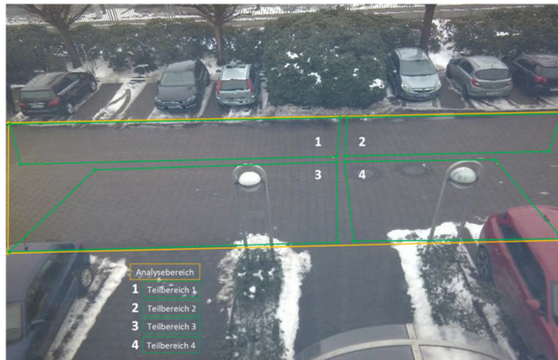
Abbildung 6.5.: Aufnahmebereich aus der Perspektive des Embedded Vision Systems inklusive des Analysebereichs und der einzelnen Teilbereiche
