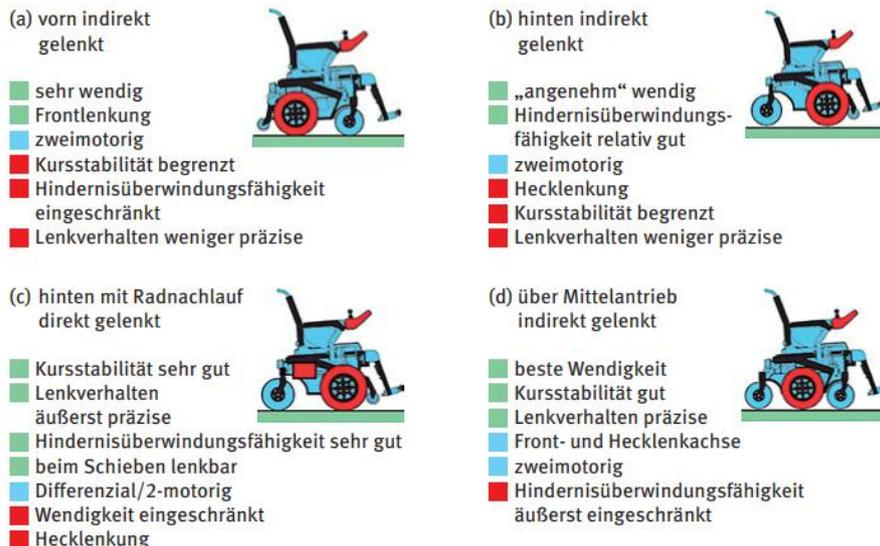
Abbildung 2-3 Farbschematische Vorteile und Nachteile eines Antriebssystems nach einer Art Elektrorollstuhl [2]
