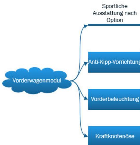
Das Vorderwagenmodul befindet sich am Elektrorollstuhl vorne in Fahrtrichtung. Der Elektrorollstuhl benötigt Beleuchtung, Anti-Kipp-Vorrichtung und Kraftknotenöse im vorderen Bereich. Der Elektrorollstuhl kann zu einem Sportrollstuhl durch das Einmontieren eines Stoßfänger an einer 3D-Knotenstruktur für Elektrorollstuhl-Fußball und Hockey nach Bedarf umgebaut werden.
