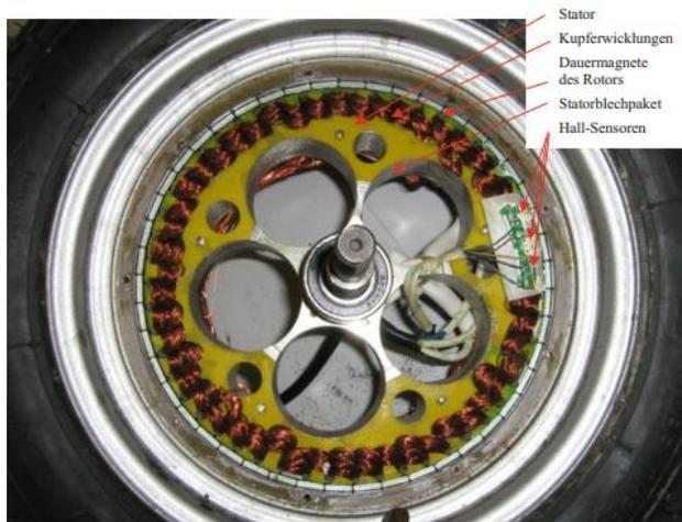
Abbildung 2-6 2kW-Radnabenmotor mit 17x3 Spulen im Stator [14, p. 132]
