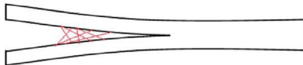
Abbildung 14: Schematische Darstellung der Faserbrückenbildung, vgl. [14], S. 3
