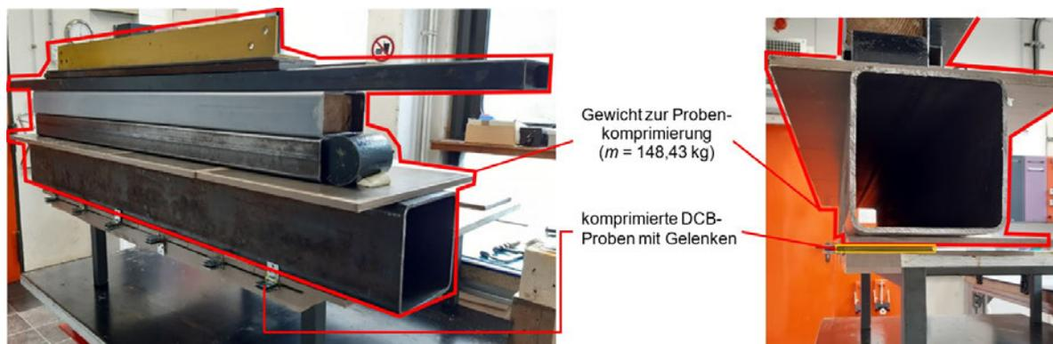
Abbildung 71: Aufbau zur Komprimierung der DCB-Probekörper (dritte Charakterisierungsiteration)
