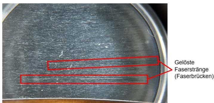
Abbildung 41: makroskopische (li.) und Lupenansicht Faserbrücken (re.) – 4 mm DCB Typ A #12
