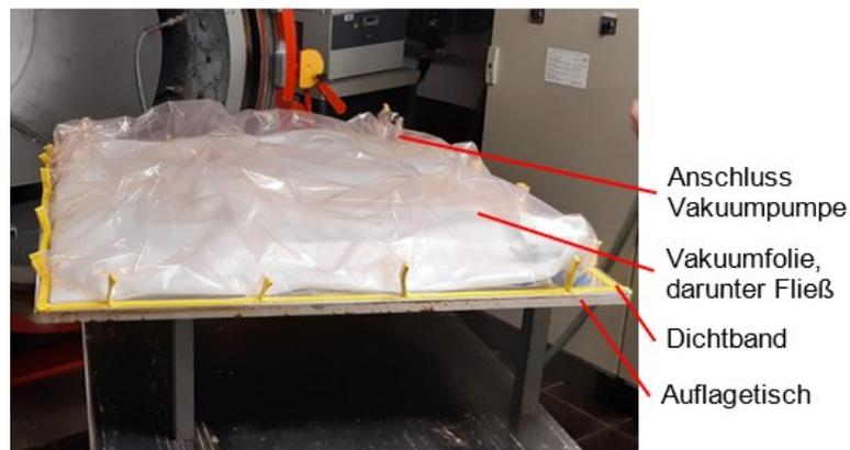
Abbildung 18: Vakuumaufbau der CFK-Laminatplatten, vor dem Aushärteprozess im Autoklaven
