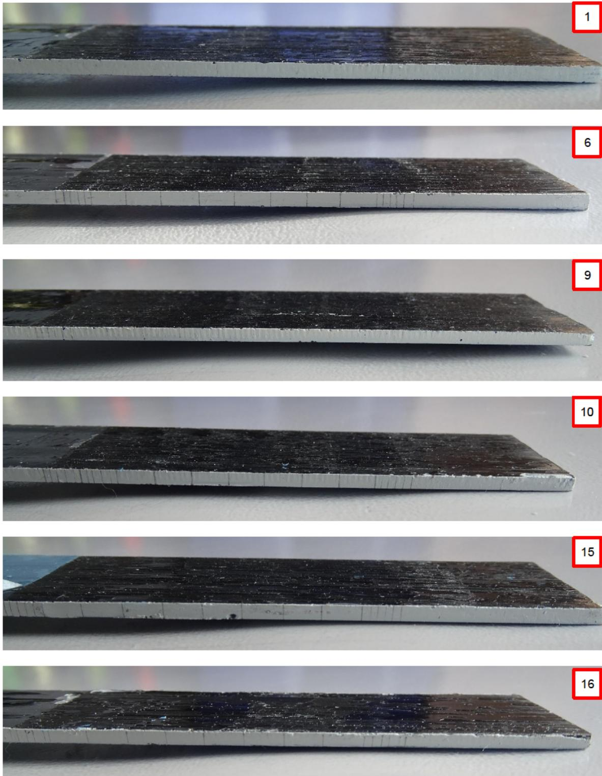
Abbildung 267: Rissflächen nach dem DCB-Test – seitliche Ansicht – 4 mm DCB Typ A2
