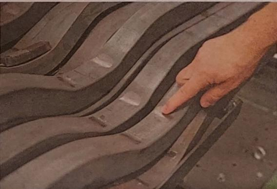
**Tiefe Dellen:** Die Stahlprofile zeigen sich schwer beeindruckt vom Aufprall des Schlittens, der mit 150-facher Erdbeschleunigung herangerauscht kam. Foto: Rudolf Stumberger
