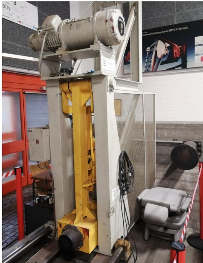
Abbildung 3: Schockprüfstand mit Schwunghammer der HAW Hamburg
