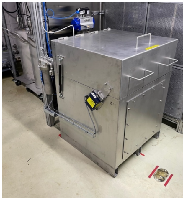
Abbildung 9: Reinigungsbehälter der Fassreinigungsanlage
