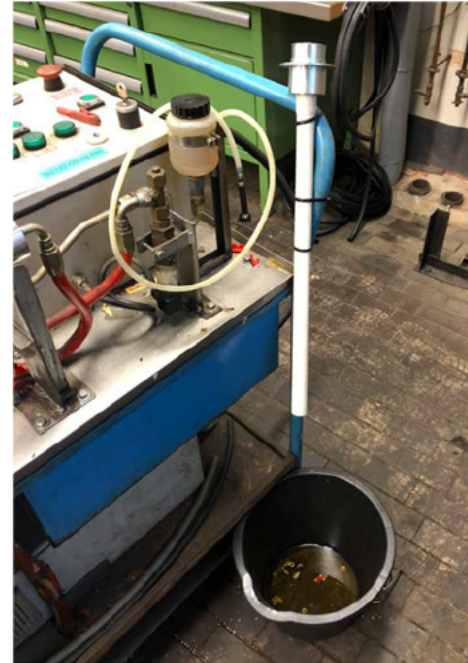
Abbildung 15: Entleervorgang des Notlöseaggregates
