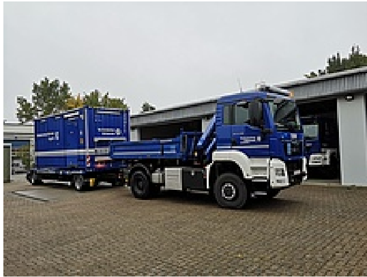
Abbildung 3.4: Werkstattcontainer auf Anhänger Plattform mit LKW Ladekran des Fachzug Logistik des THW [3]
