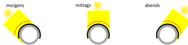
Abbildung 8: Sonneneinstrahlung auf die Dünnschichtzelle (TubeSolar AG, 2020)
