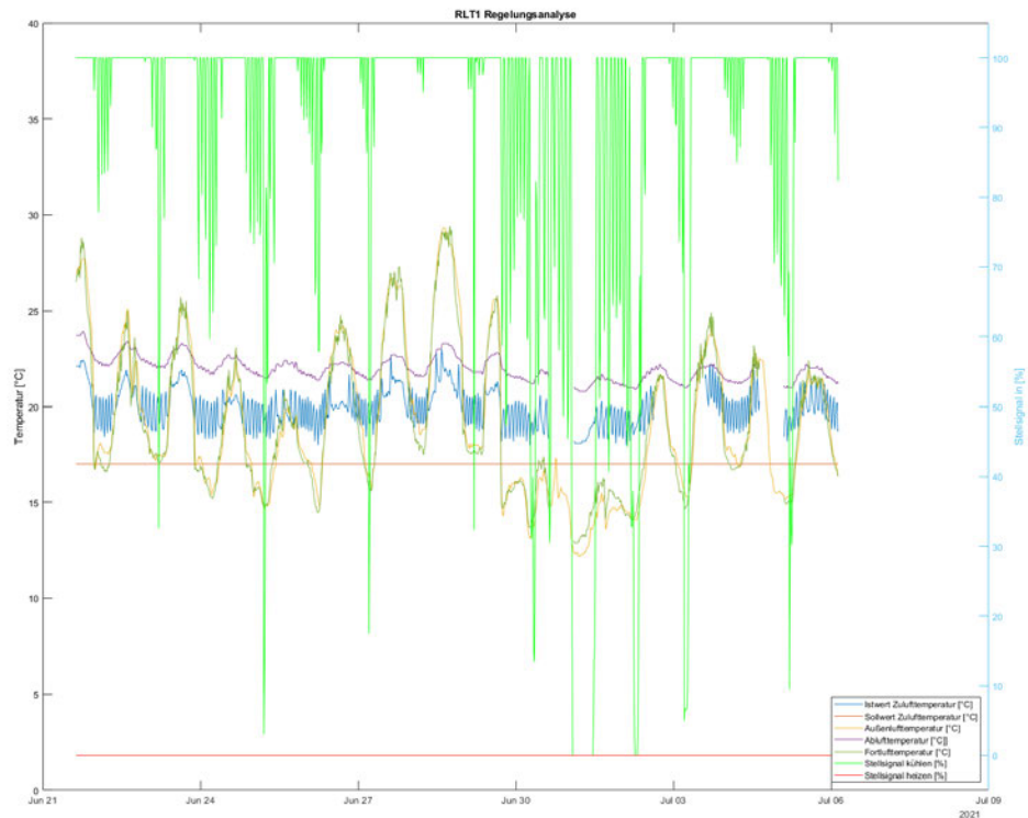
Abbildung 5.26: Analyse Temperaturregelung RLT Anlage 1
