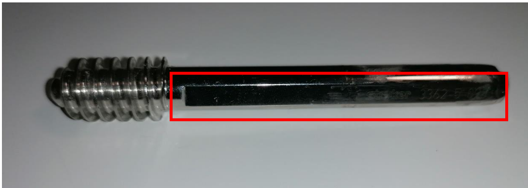
Abbildung 2-25: GS mit abgegrägten Kanten
