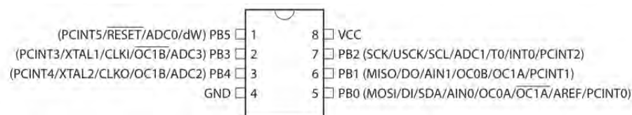
Abb. 5.16: Pinout des ATtiny85-Mikrocontrollers [20]
