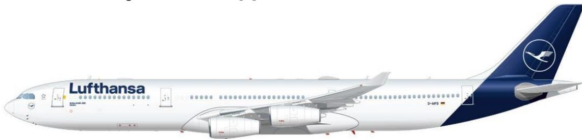
Abbildung 2-1: Airbus A340-300 mit CFM56-5C Triebwerken [8]
