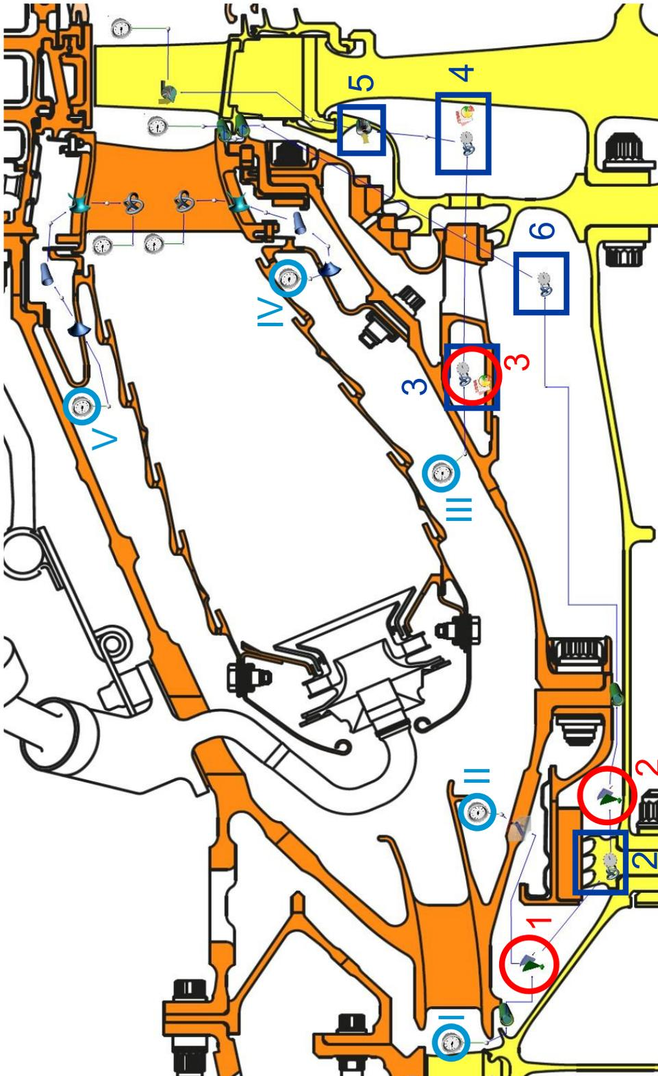
Abbildung D-1: Flownex HPT-System, in blauen Rechtecken neue Elemente für die Validierung, rot umkreist Messstellen für die Validierung, in hellblau umkreist Stellen für die Zufuhr von Luft in das Sekundärluftsystem
