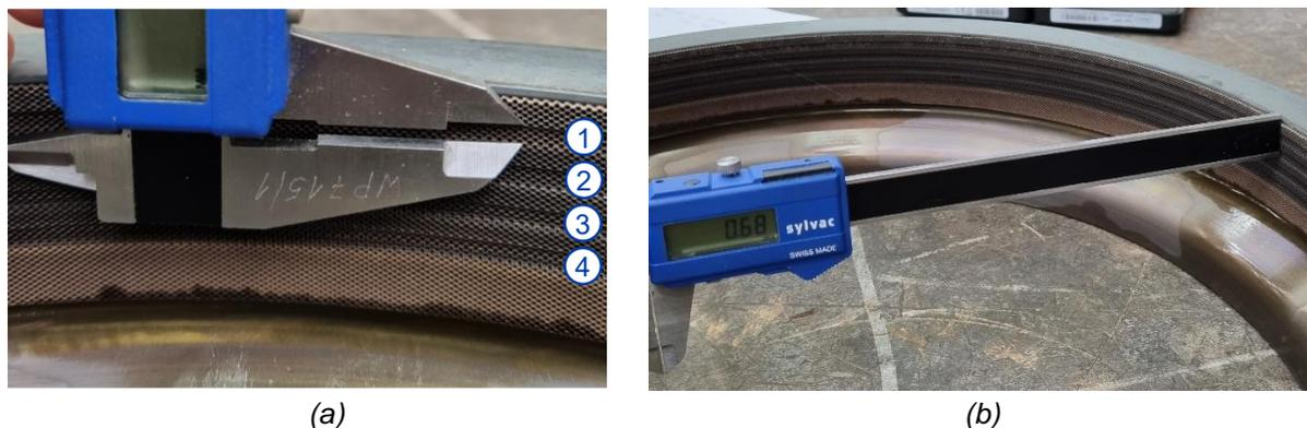
Abbildung 6-1: Vermessung der unteren Furchenbreite (a) und der Furchentiefe (b)
