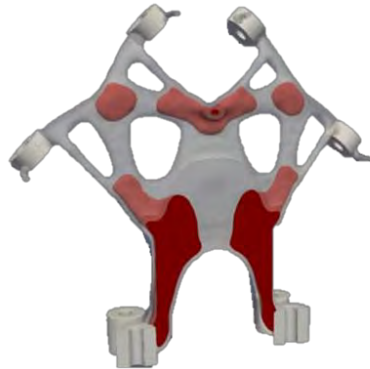
Abbildung 14: Mit CogniCAD™ strukturoptimierte Multimaterialstruktur [45]
