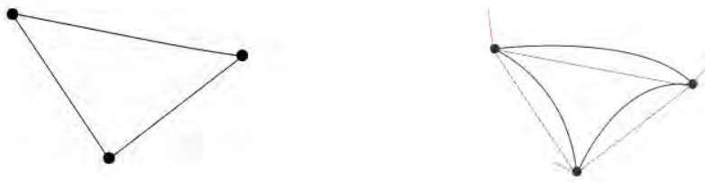
Abbildung 6: Links: Standard-Dreiecksfläche, rechts: gekrümmte Dreiecksfläche [14]
