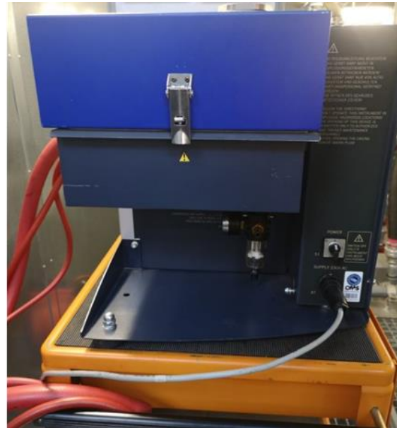
Abbildung 32: Anschlüsse des Opazimeters rechte Seite
