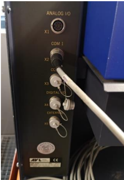
Abbildung 31: Anschlüsse des Opazimeters linke Seite
