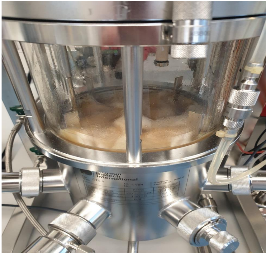
Abbildung 5: Kultivierung von E. coli DH10 beta im Bioreaktor BIostat® CTB. Der Bioreaktor ist mit 3 L Glycerolmedium (2) und 300 mL Inokulum gefüllt. Durch Sonden wird der pH-Wert, die Temperatur und die Gelöstsauerstoffkonzentration gemessen und durch Zugabe von Säure und Lauge, durch eine Heizung und durch den Rührer geregelt.
