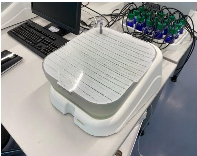
Abbildung 21: AMPTs II - Gaszähler von außen (links)
