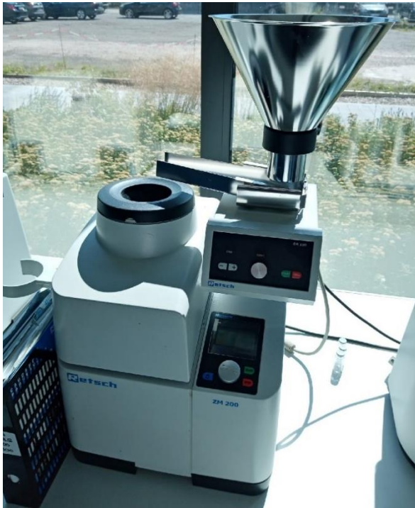
Abbildung 16: Mazerator Retch ZM-200 (links)
