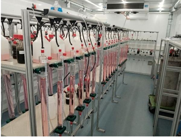
Abbildung 24: GB-21 mit Eudiometern, Klimaraum (links)
