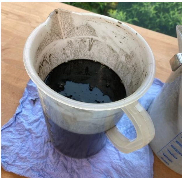
Abbildung 18: Inoculum (Klärschlamm) vor der Vorbehandlung (Volumen ca. 3 L.)
