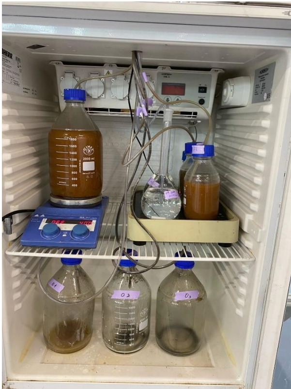
Abbildung 27: Kühlschrank mit Ein- und Ausfluss Lösungen
