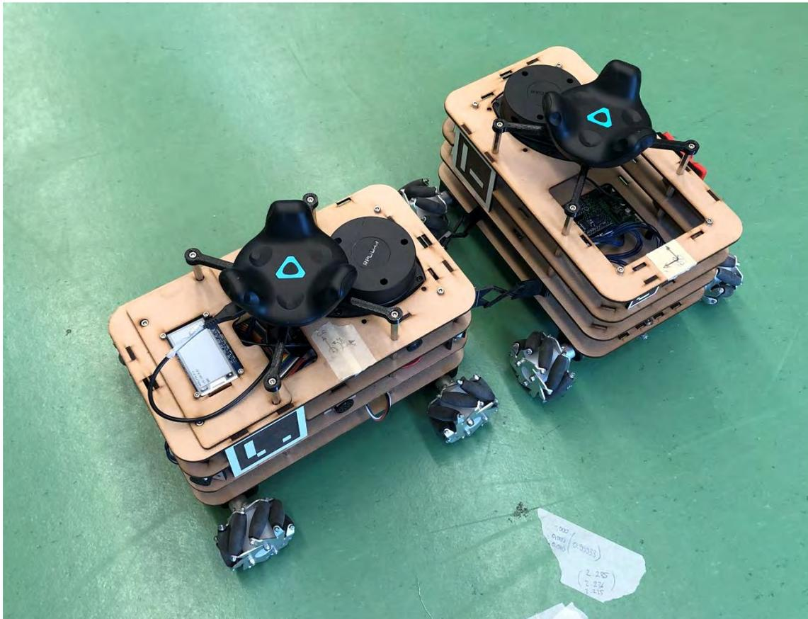
Abbildung 49: HIVE-BEE Kombination für den Multi-Roboter-Steuerungstest
