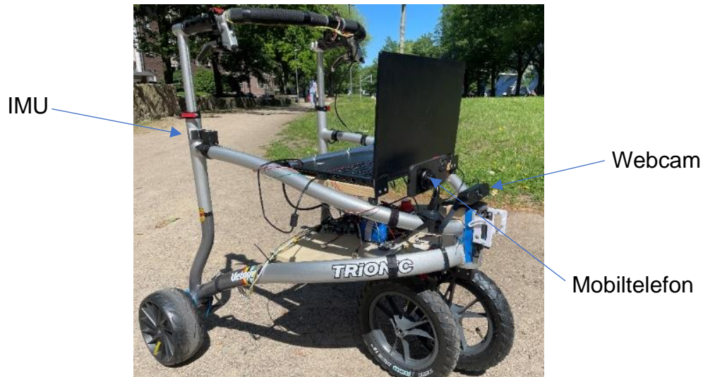
Abbildung 21: Prototyp des „Shared Guide Dog 4.0“
