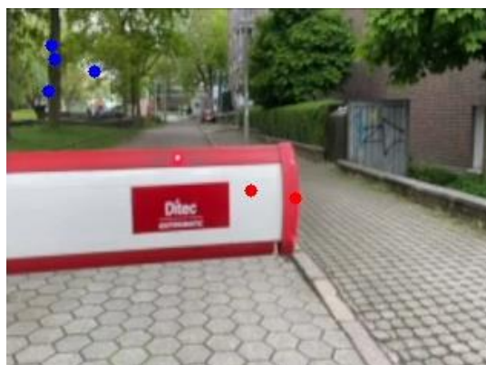
Abbildung 29: Ergebnisse nach Anwendung des Template Matchings
