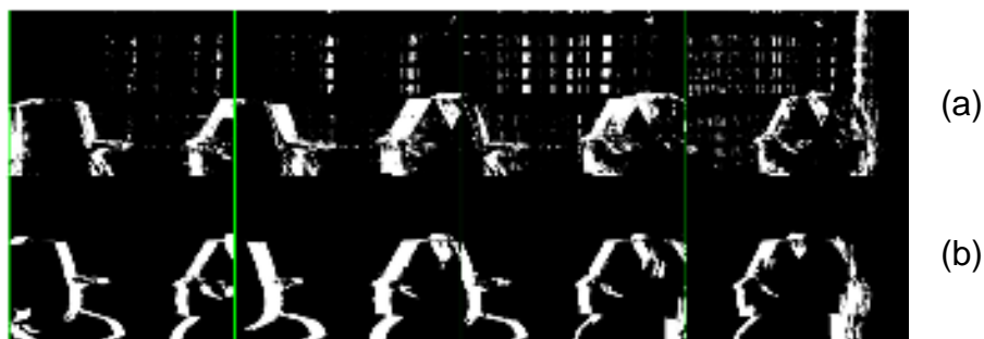
Abbildung 13: Konturendetektion und Filterung a) detektierte Konturen b) detektierte Konturen gefiltert [14]
