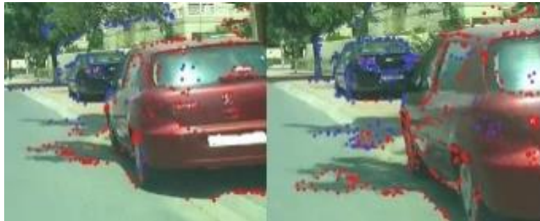
Abbildung 14: Segmentierung mittels optischen Flusses (rot: nah und blau: fern) [14]
