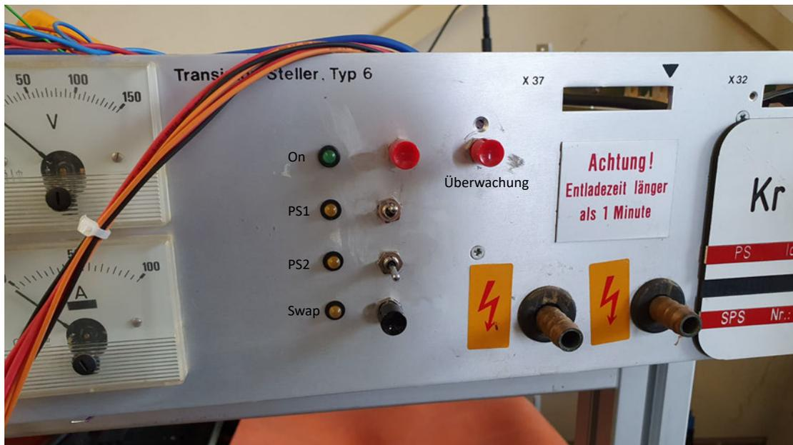
Abbildung 6.3: Frontalansicht auf ein umgebautes Gehäuse mit Bedienung des Redundanz-Managers
