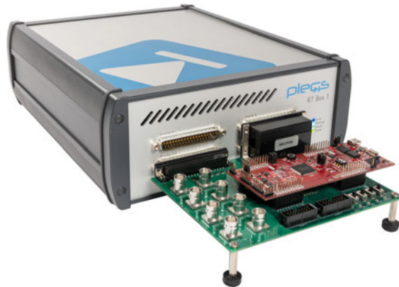
Abbildung 4.2: Aufbau der RT Box 1 mit einem Mikrocontroller und dem LaunchPad Interface [30]
