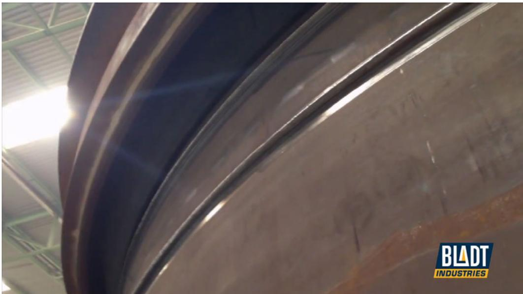
Abbildung 1.2.: Geschweißte Schubrippe am Pile - Screenshot aus dem Video [9]
