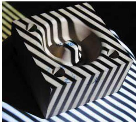
Abbildung 36 Beispielbild: Streifenmuster auf einem Objekt (150 x 150 x 90mm<sup>3</sup>) [23]
