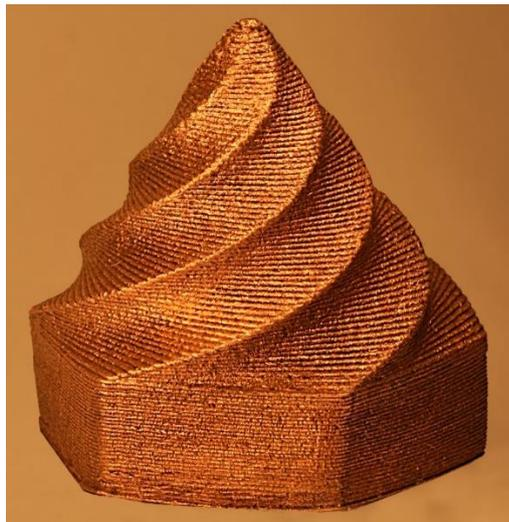
Abbildung 5 Mit FDM-Verfahren gedruckter metallischer Konus [8]
