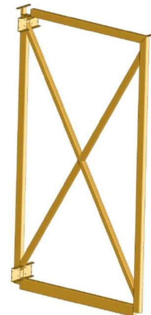
Abbildung 27: Zwischenwand des Aufbaus
