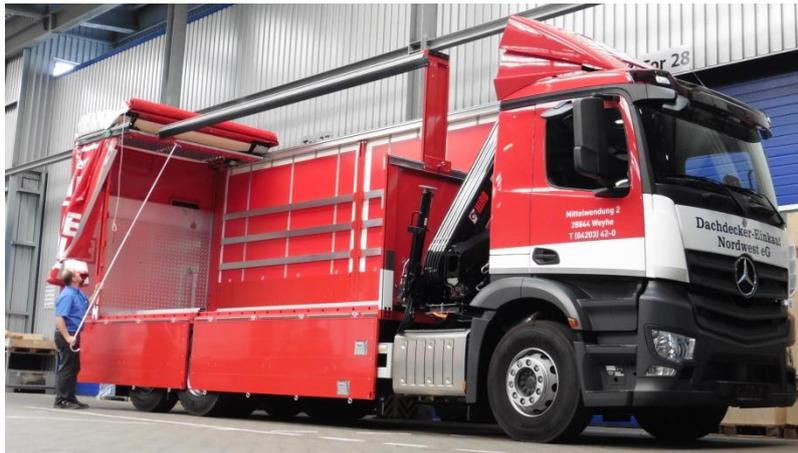
Abbildung 8: Curtainsider Verdeck mit verfahrbarem Dachgurt (5)
