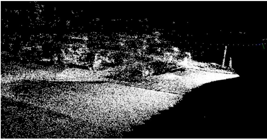
Abbildung 2.4.: Rekonstruierte Punkte einer Szene. Aus 104 Aufnahmen rekonstruierte Parkplatz Szene (vgl. Tabelle A.2 in Anhang A) (93466 Punkte).
