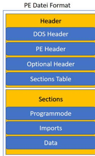
Abbildung 2.2: Obergeordnete Komponenten des PE Dateiformats
