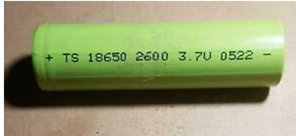
Abbildung 7-8: Die Lithium-Zelle TS 18650.
