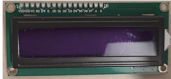
Abbildung 7-18: Das verwendete LCD 1602.
