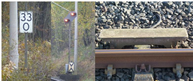
**Abb. 2.1:** Zugbeeinflussungssysteme: Schild, Signal und Gleismagnet (eigenes Foto)
