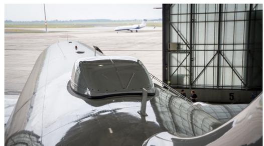
Abbildung 6-2: Connectivity-Antenne mit Radom (A320) [36]
