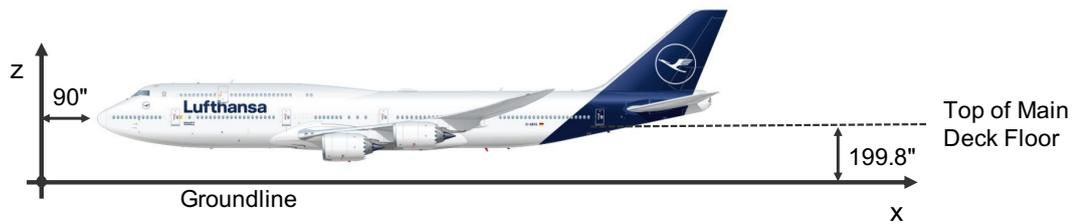
Abbildung 3-2: Struktur-Koordinatensystem am Beispiel der Boeing 747-8 [20]
