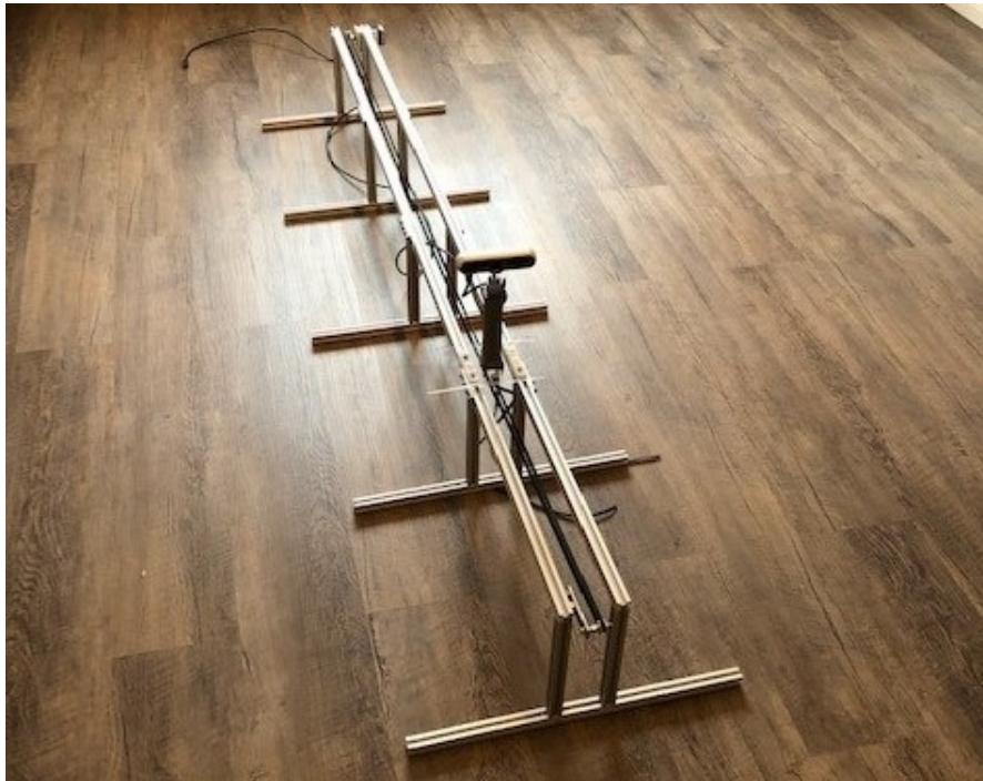
Abbildung 6.2: Hardware Teststand mit montierter Kamera
