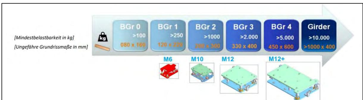
Abbildung 11: Zukünftige Entwicklung unterschiedlicher Baugrößen des EASy's [10]
