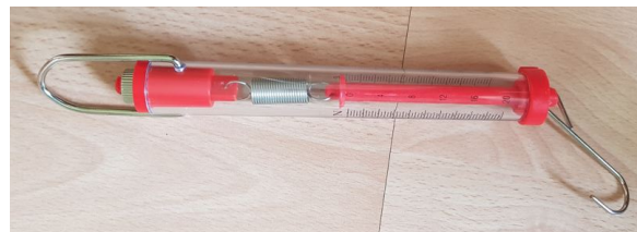
Abbildung 5.9: Kraftmesser für die Zugkraftmessung
