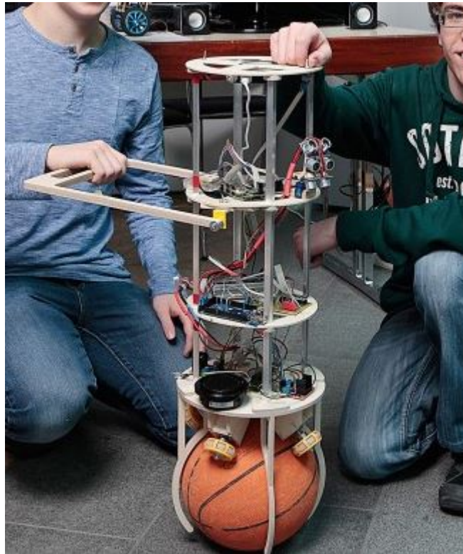
Abbildung 3.2: Blindbot mit Ballsystem als Antrieb. Entwickler: Alexander Bayer und Niklas Gutmiedl[29]
