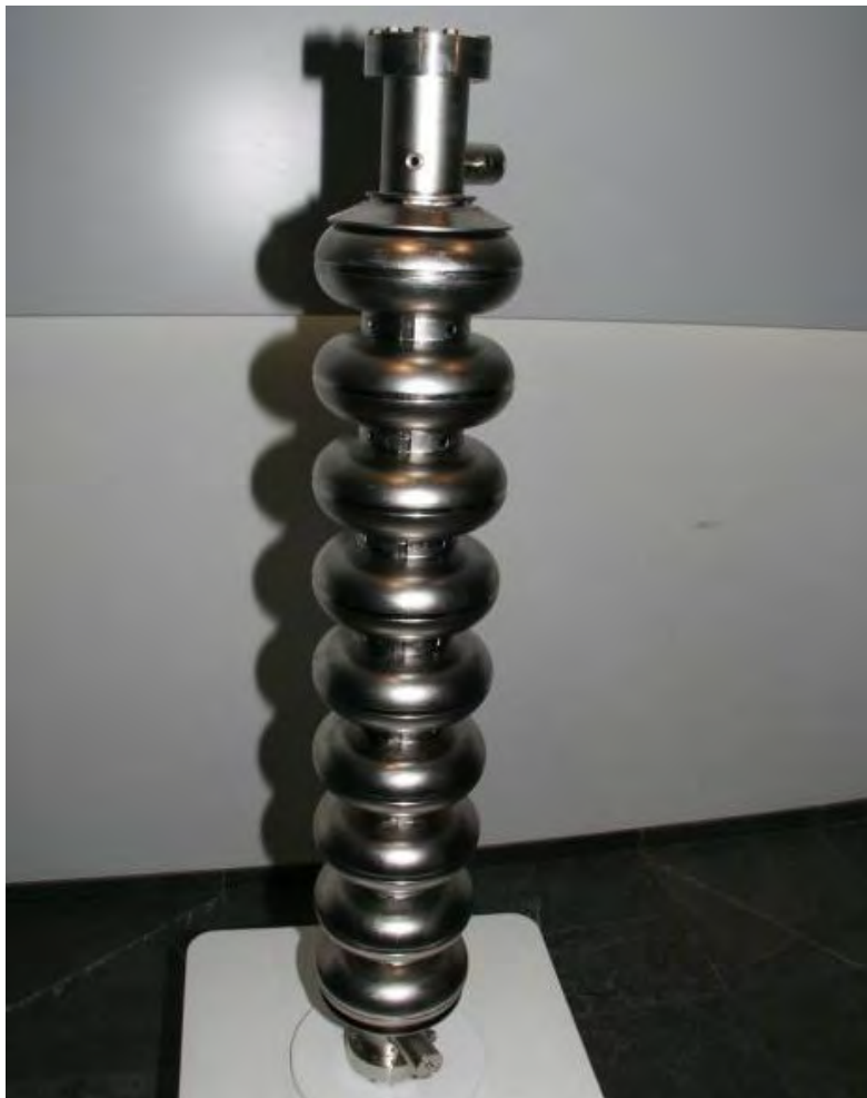
Abbildung 4.2: Supraleitender Hohlraumresonator aus Niob [8]
