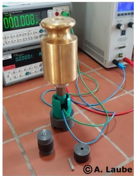
Abbildung B.5: Links: Messaufbau der Leitfähigkeitsmessung der additiv gefertigten Titanröhren; Rechts: Messaufbau mit aufgelegtem Gewicht, Distanzhülsen und Proben
