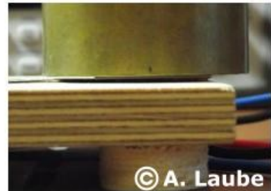
Abbildung B.3: Links: Positionierung der Quadrate aus expandiertem PTFE; Rechts: Position des expandierten PTFE zwischen Titanvlies und Gewicht
