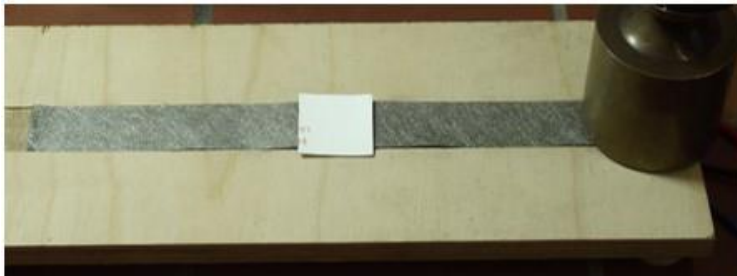
Abbildung B.3: Links: Positionierung der Quadrate aus expandiertem PTFE; Rechts: Position des expandierten PTFE zwischen Titanvlies und Gewicht
