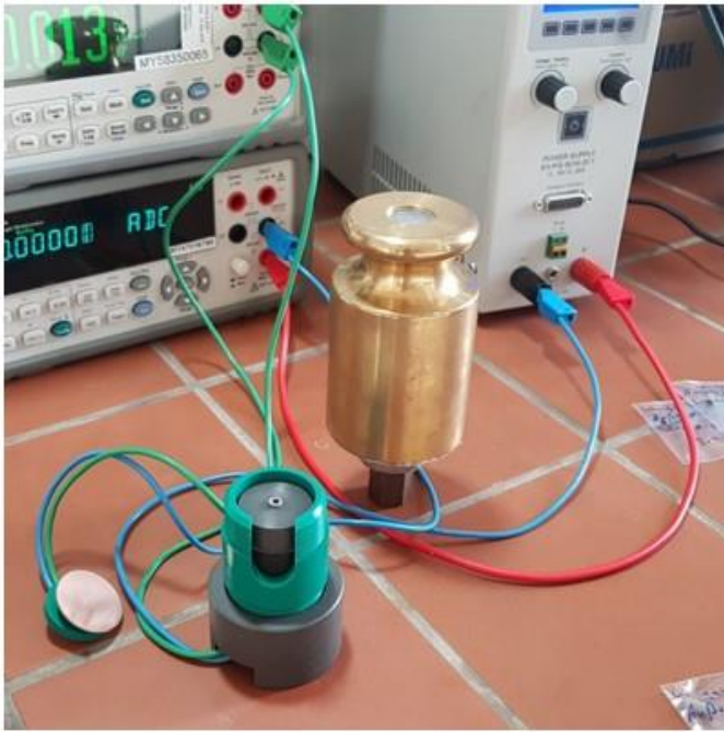
Abbildung B.5: Links: Messaufbau der Leitfähigkeitsmessung der additiv gefertigten Titanröhren; Rechts: Messaufbau mit aufgelegtem Gewicht, Distanzhülsen und Proben
