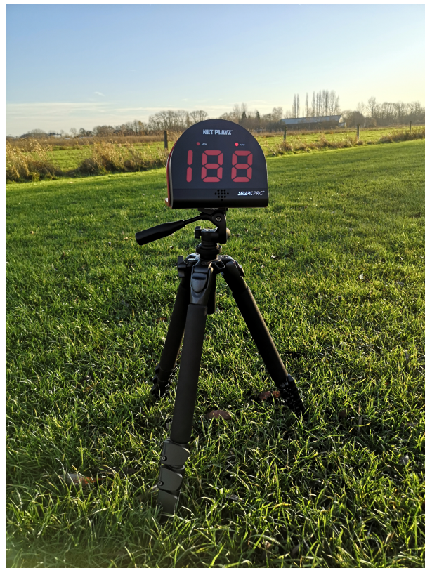
Abbildung 3.2: Radar-Messgerät auf einem Kamerastativ
