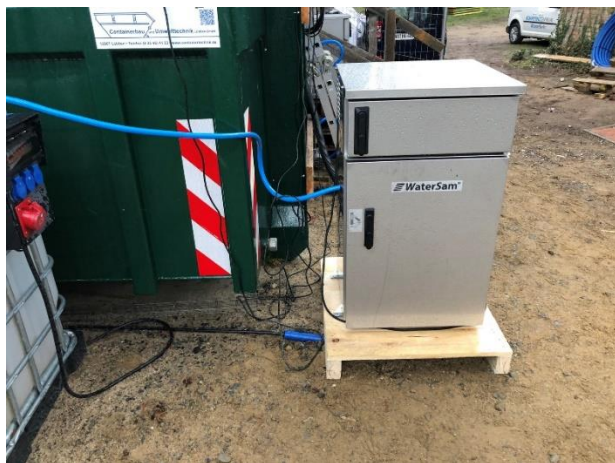
Abbildung 14: Automatisierter Probenehmer WaterSam am Ablauf des BBF1
