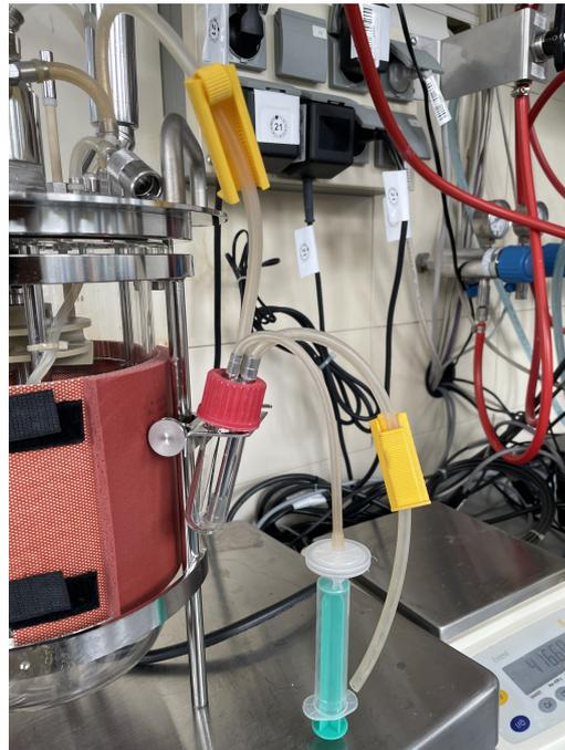
**Abbildung 4.3:** Die Instrumentierung zur Probenahme. Nach dem Öffnen der oberen Schlauchklemme kann mit der Laborspritze eine Probe aus dem Bioreaktor aufgezogen werden. Durch Schließen der oberen und dem Öffnen der unteren Schlauchklemme kann die Probe aus dem Röhrchen gepumpt werden.
