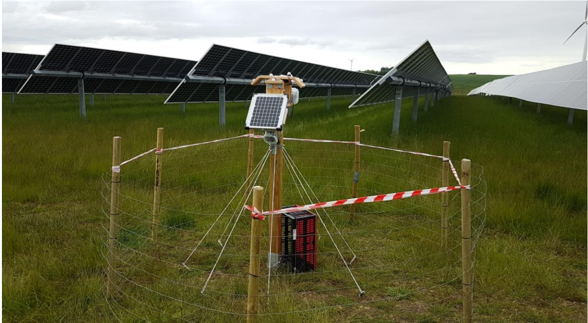
Abbildung 14 Ost/west-trackende und programmierbare Sensorstation RAGMAR. RAGMAR wurde am 30.05.2022 auf der PVF X aufgebaut. Im Hintergrund sind die Trackerreihen der PVF X erkennbar, die sich auf fast maximaler West-Position befinden. Die Umzäunung RAGMAR's dient als Schutz vor Schafen (eigenes Foto).
