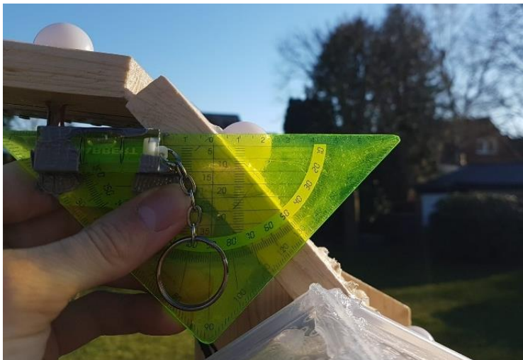
Abbildung 15 Kalibrierung des Neigungssensors. Der Neigungssensor, der unterhalb des Trackers mit Silikon an der Trackingebene festgeklebt ist, wird mit Hilfe eines Geodreiecks kalibriert, an dem sich eine kleine Wasserwaage befindet. Für die endgültige Kalibrierung wurde die Wasserwaage mit Silikon am Geodreieck befestigt (eigenes Foto).
