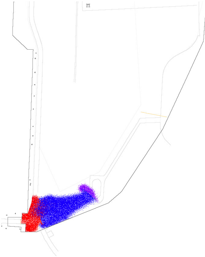
Abbildung 20: Situation am Tor 9 während der Räumung nach 25 Minuten ("PedGo," 2023)
