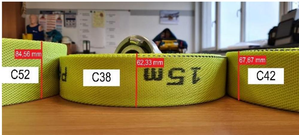
Abbildung 8: Schlauchhöhen im Vergleich (eigene Darstellung)
