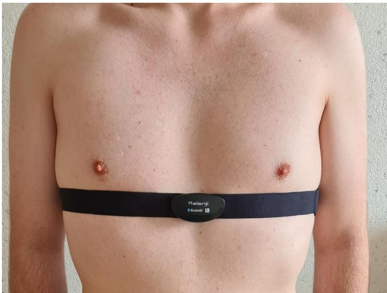
Abbildung 11: Position des getragenen Herzschlagfrequenzsensors mit Brustgurt (eigene Darstellung)
