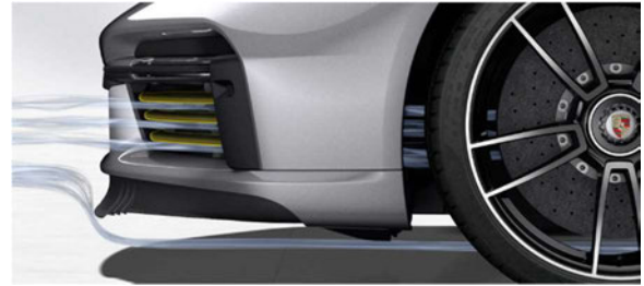
Abbildung 1-6: Kühlluftklappe geöffnet mit Luftstrom, Quelle: [8]
