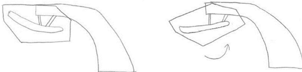
Abbildung 2-10: Schwanenhalsprinzip, Quelle: In Anlehnung an [15]
