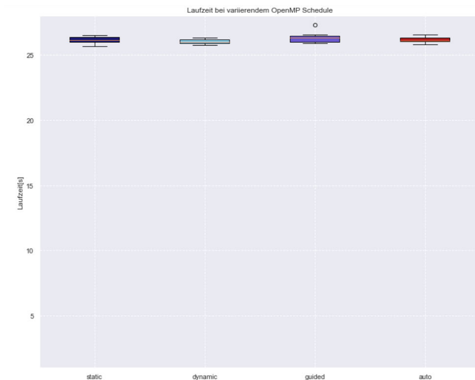
Abbildung 6.6: Laufzeitverhalten bei variierenden Ablaufplänen
