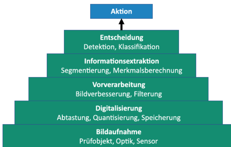
Abbildung 2.6: Abfolge einer automatischen Sichtprüfung in Anlehnung an [2]
