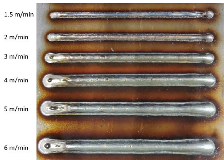
Abbildung 8.2: Vergleich der Nahtgrößen mit unterschiedlichen Drahtvorschubgeschwindigkeiten
