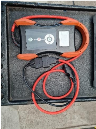
Abbildung 25: HU-Adapter als Messgerät
